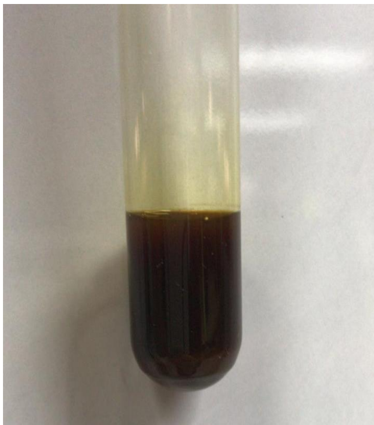
Figura 44. Prueba de Lugol (Determinación de Almidón) para la Fracción Acuosa uno (AQ 1 ) de la Bidens pilosa
