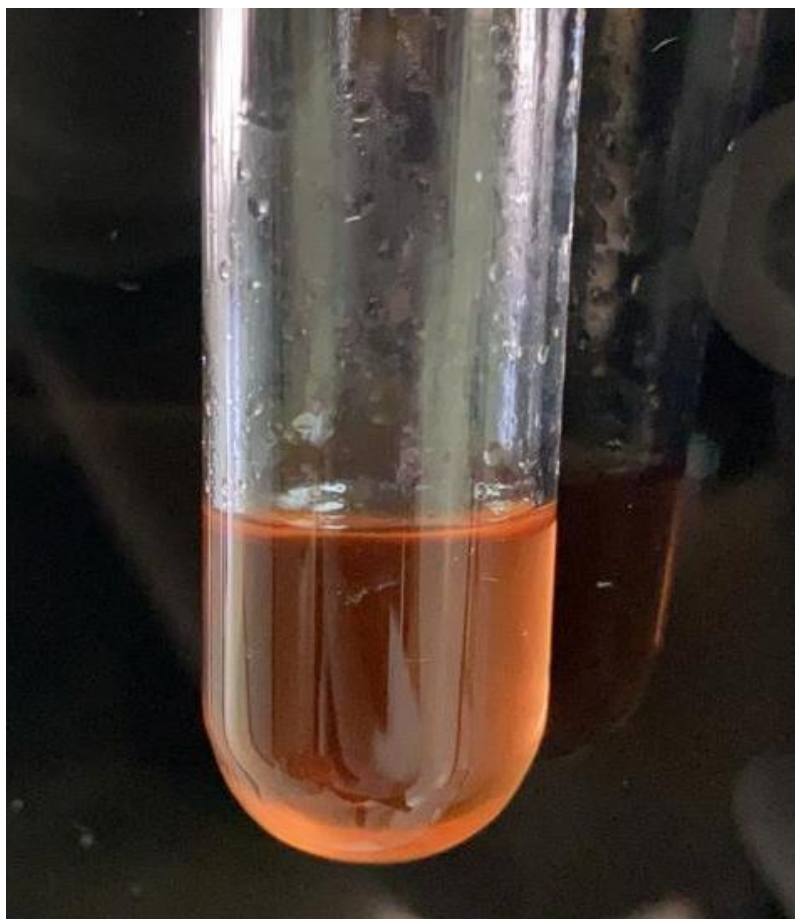
Figura 51. Prueba de Shinoda (Identificación de Flavonoides) para la Fracción Acuosa dos con Éter Hidrolizado (AQ 2 E) de la Bidens pilosa
