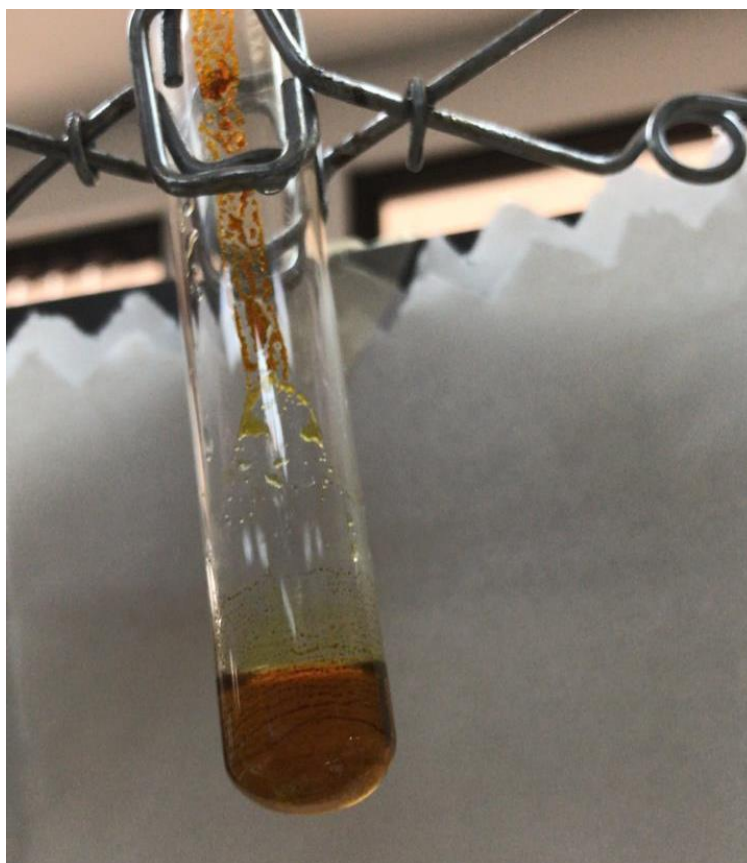
Figura 35. Prueba de Dragendorff (Identificación de Alcaloides) para la Fracción Etérea Hidrolizada de la Bidens pilosa
