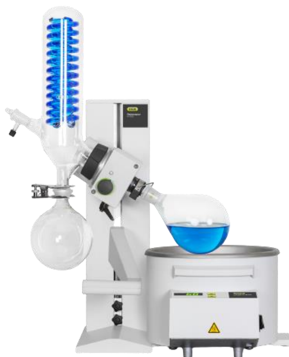
Figura 22. Equipo de Destilación a Presión Reducida Mediante Rotavapor.
