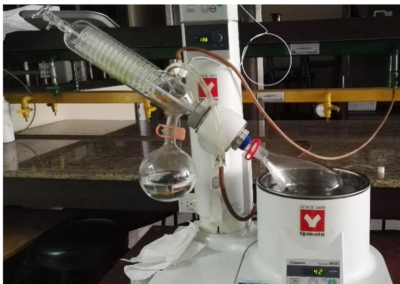
Figura 9: Métodos para la Purificación del Aceite Esencial Thymus vulgaris , Mediante el Uso del Rotavapor
