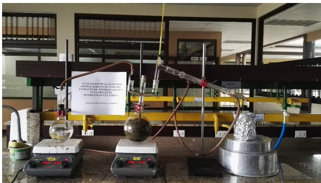
Figura 7: Equipo para Arrastre de Vapor
