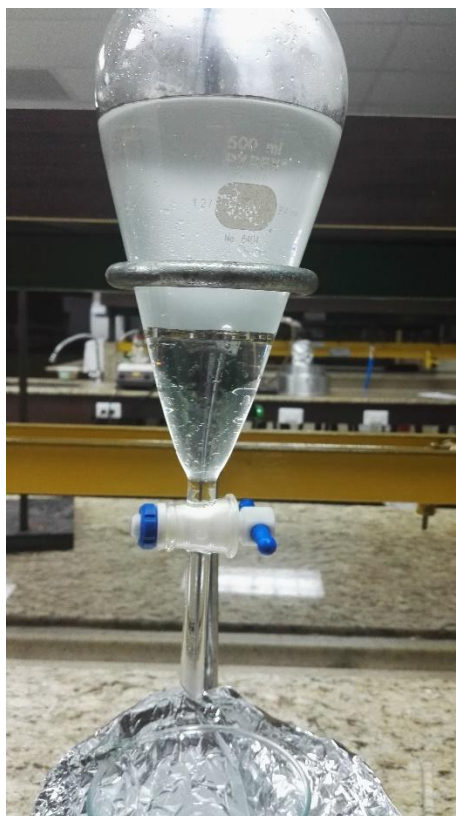
Figura 18: Extracción Líquido-Líquido en Embudo Separador del Aceite Esencial con Diclorometano
