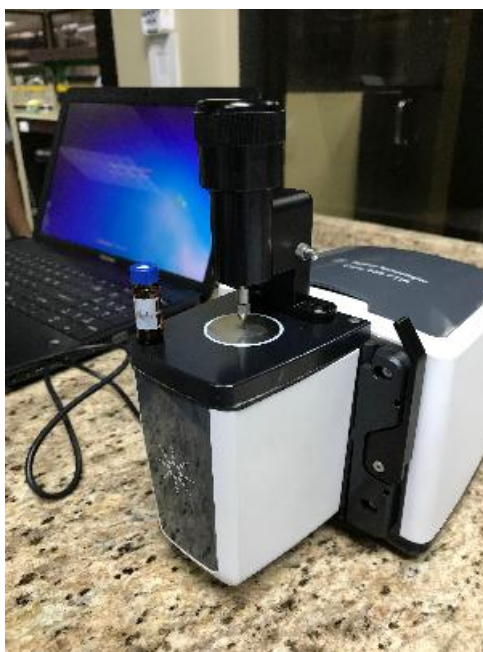
Figura 13 Espectrofotómetro Infrarrojo IR usado para la identificación de grupos funcionales de compuestos orgánicos en el aceite esencial de C. citratus .
