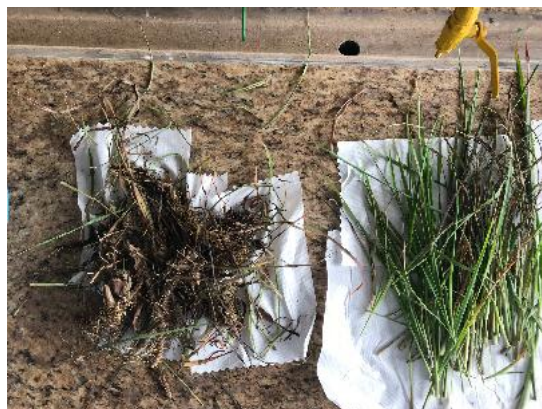
Figura 21. Separación del material que fue sometido al proceso de extracción por el método de arrastre con vapor y aparato Dean-Stark.
