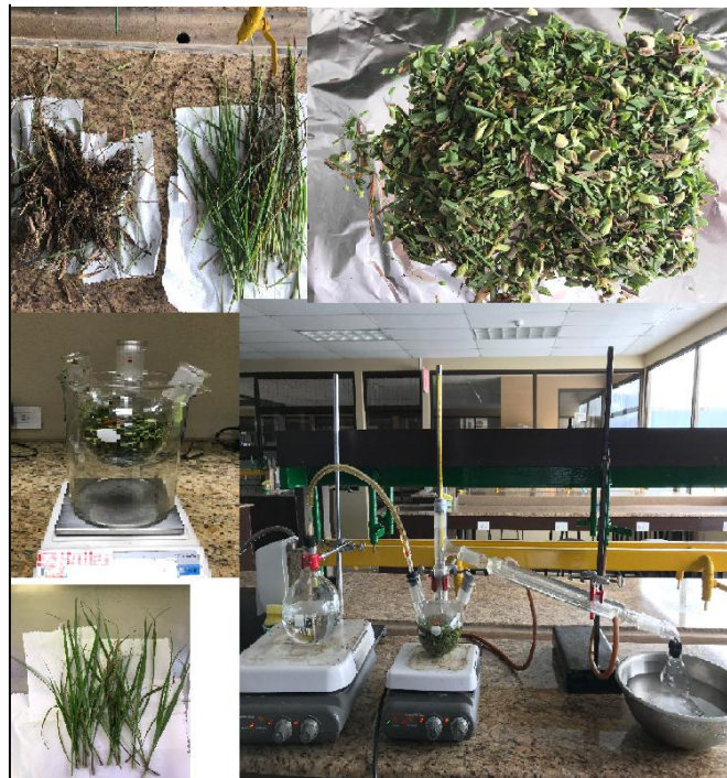
Figura 10. Método de extracción del aceite esencial de C. citratus por arrastre con vapor.
