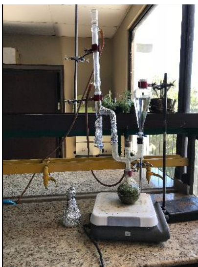
Figura 11. Equipo Dean-Stark empleado para la extracción de aceite esencial de C. citratus .
