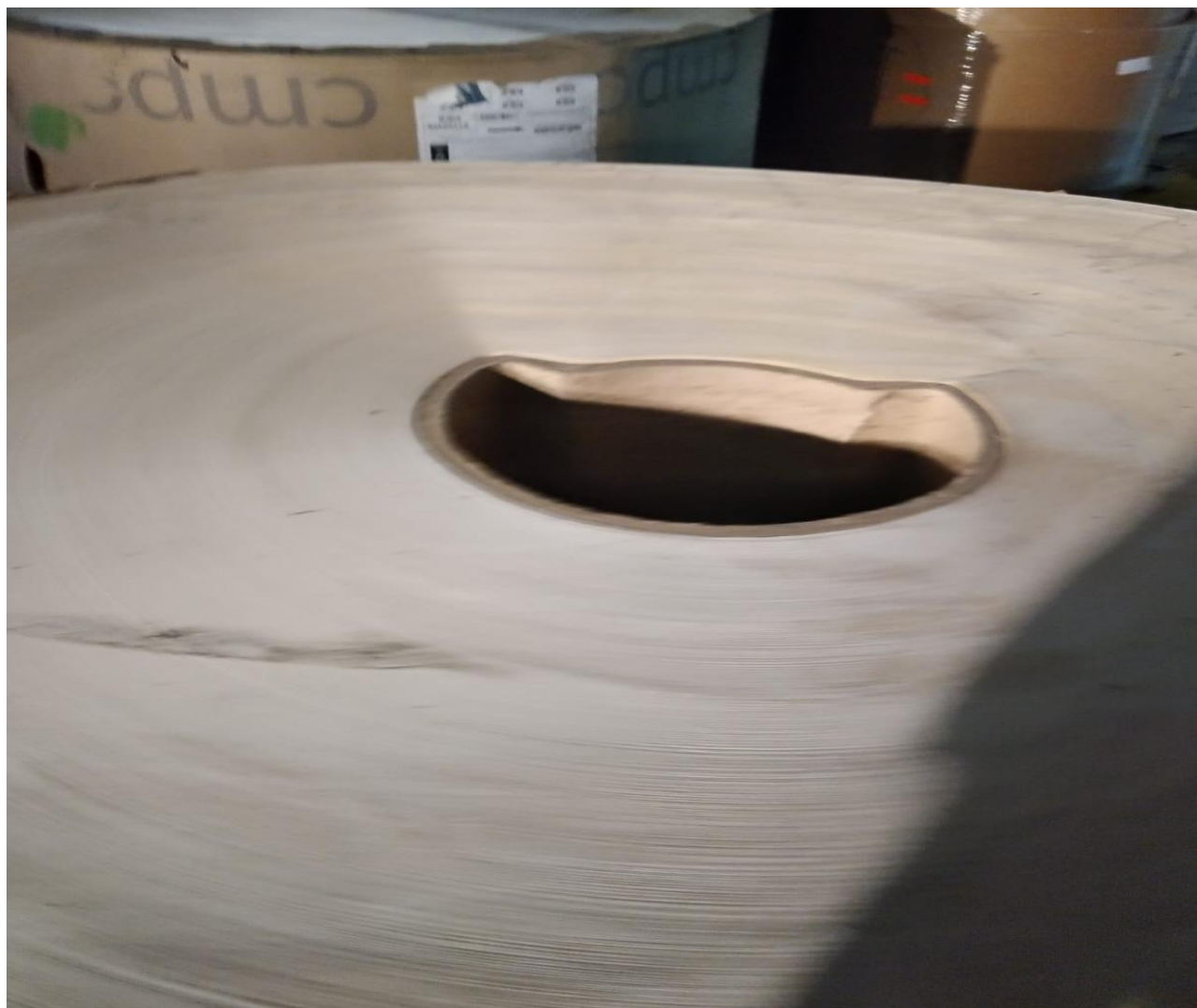
Figura 30: Evidencia Bobina Golpeada #2
