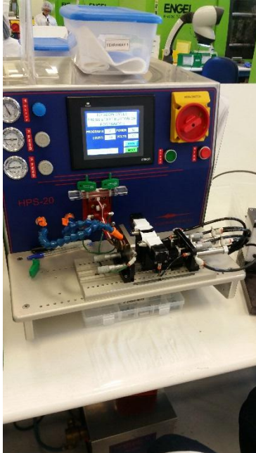
Figura 24 Estación de tipping
