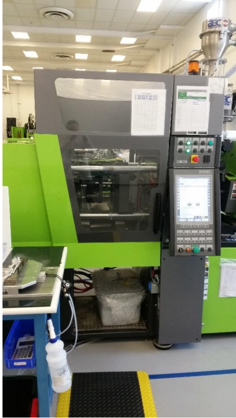
Figura 22 Estación de moldeo
