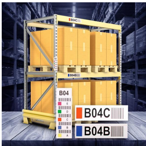
Figura 47: Ejemplo de rotulación de Racks
