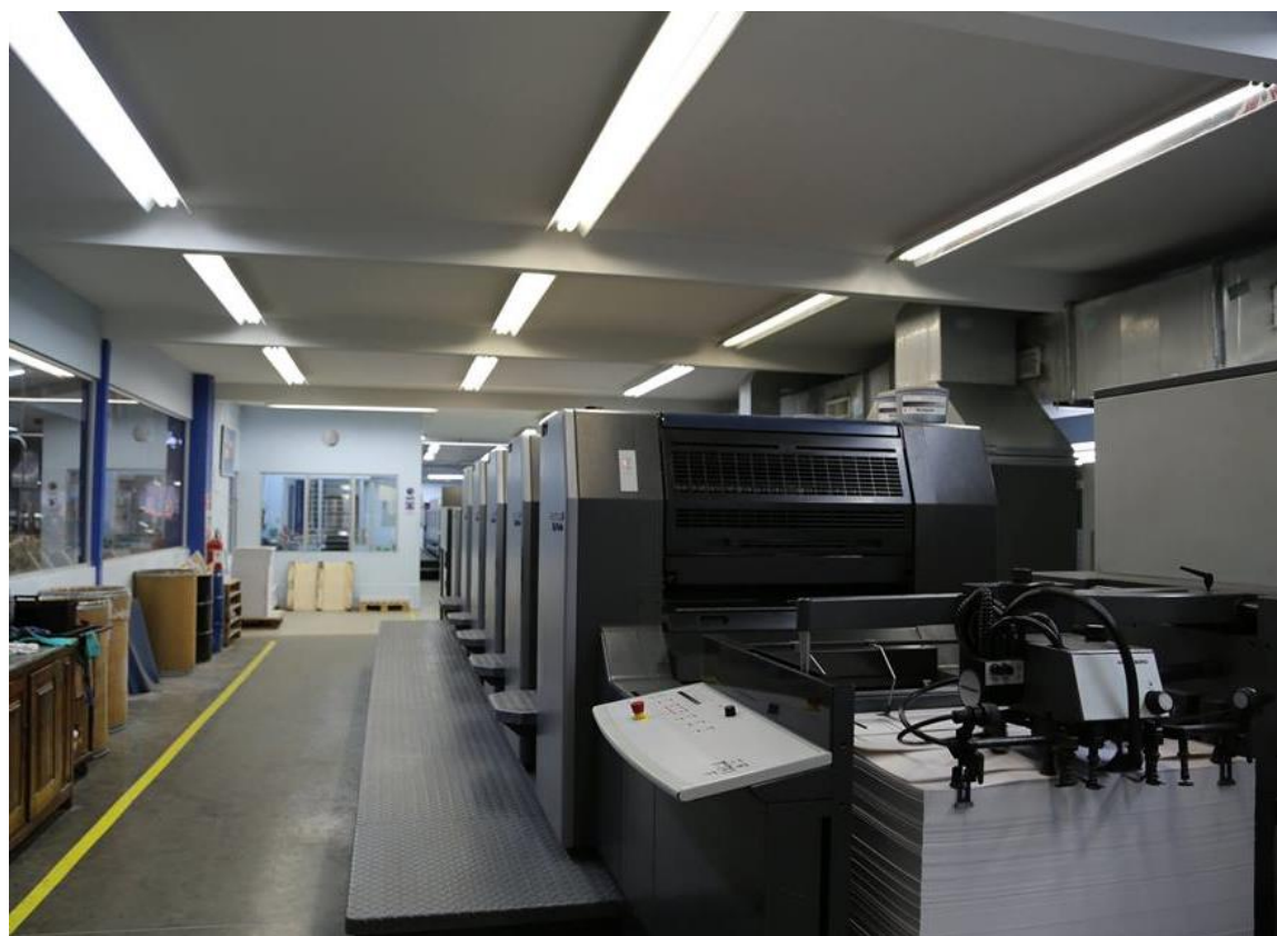
Figura 12. Impresora Offset Heidelberg SM 74
