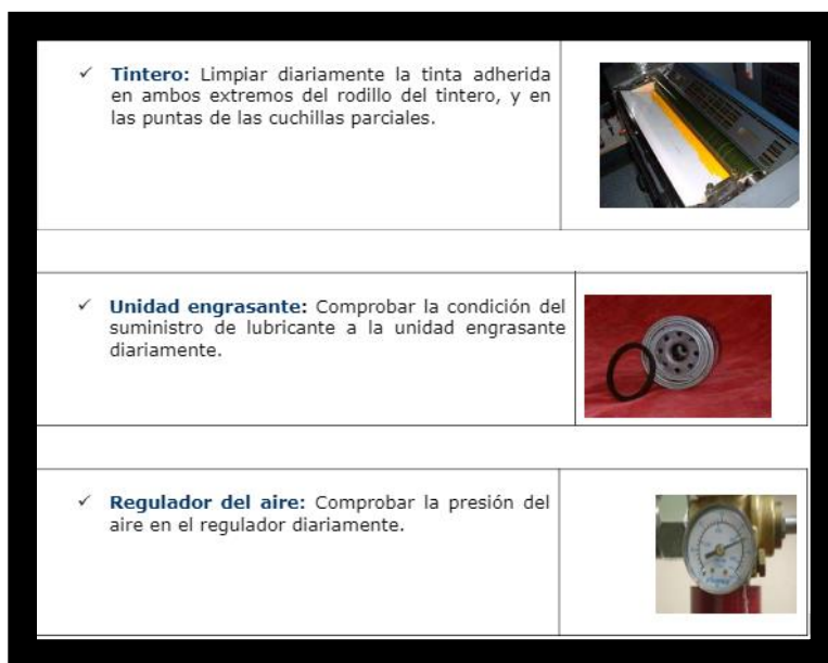
Figura 55. Control visual de limpieza de equipos
