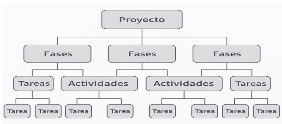
Figura 15 Ejemplo de estructura de descomposición de trabajo.
