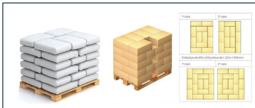
Figura 1: Ejemplos de estiba entrelazada en tarimas
