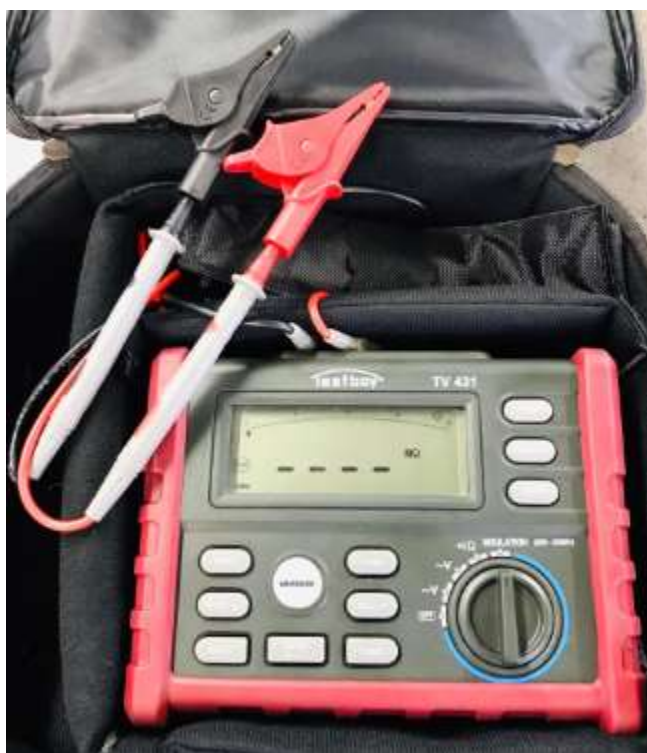
Figura 36. Medidor de aislamiento
