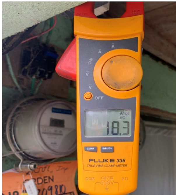
Figura 17 Consumo de corriente eléctrica de la bomba
