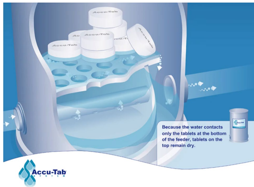
Figura 22 Funcionamiento sistema clorador Accu-Tab
