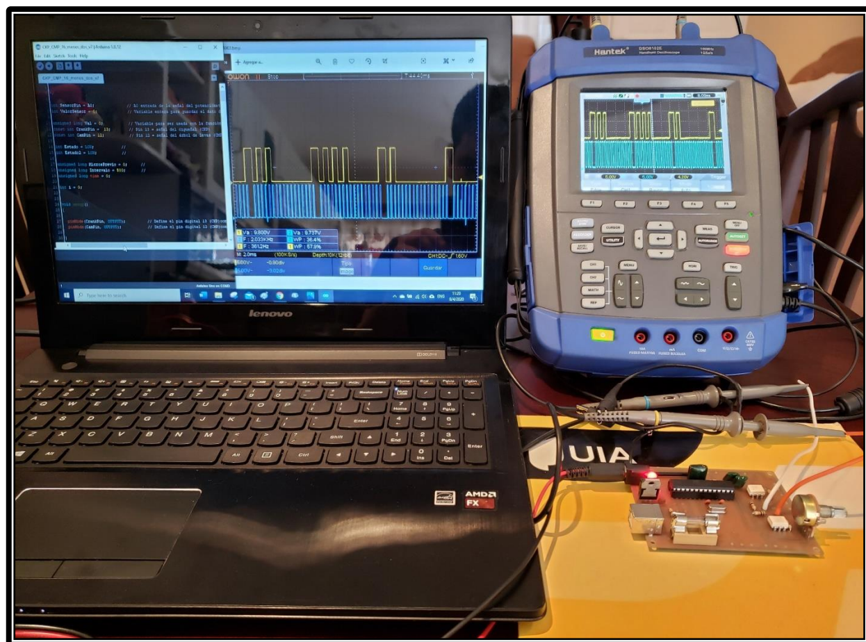
Figura 46. Señales CKP del vehículo versus señales generadas por el módulo emulador. Fuente: elaboración propia.
