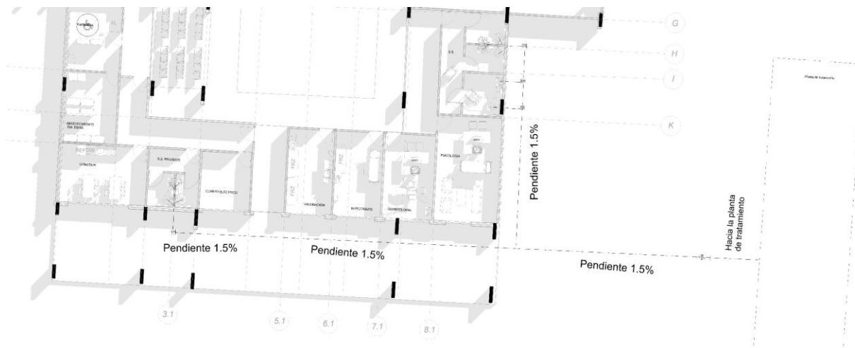
Ilustración 123 Planta Mecánica de aguas negras, fuente propia
