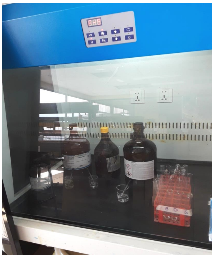
Figura 32. Cámara de Extracción de Gases
