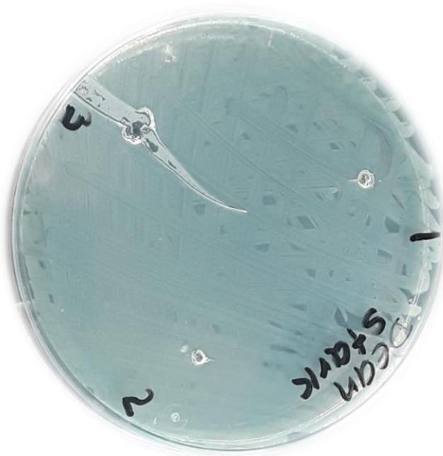
Figura 60. Resultado de la Prueba de Sensibilidad Microbiana de S. aureus con Soluciones del Aceite de L. candidum Obtenidas por el Equipo Dean-Stark
