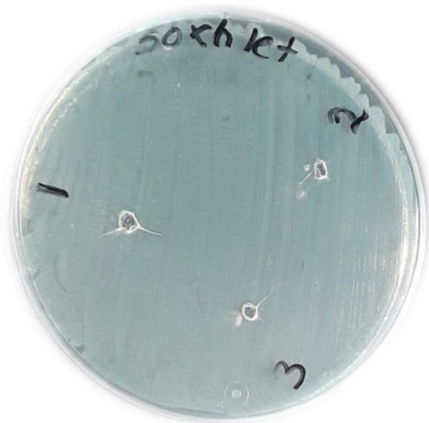
Figura 60. Resultado de la Prueba de Sensibilidad Microbiana de S. aureus con Soluciones del Aceite de L. candidum Obtenidas por el Equipo Dean-Stark
