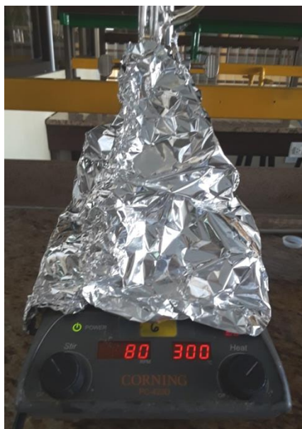
Figura 37. Papel Aluminio Alrededor del Balón de Fondo Plano y Calentador
