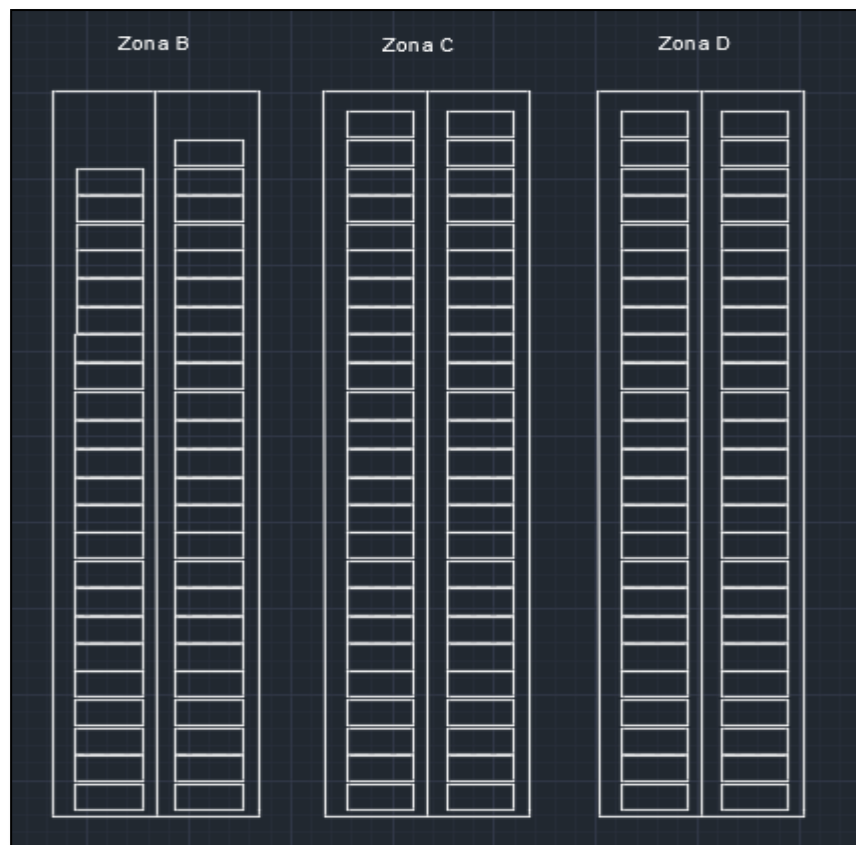
Figura 15. Acomodo de los 147 paneles solares Fuente: Elaboración Propia
