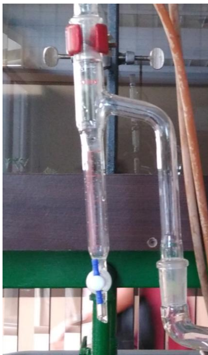
Figura 13. Equipo de Destilación Empleado para la Hidrodestilación con el Aparato de Dean-Stark
