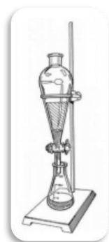
Figura 26. Montaje de Equipo de Extracción
