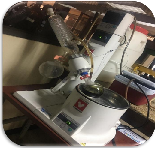
Figura 24. Equipo de destilación por rotavapor Yamato, modelo BM500.
