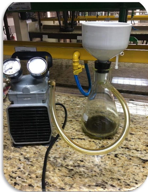
Figura 33. Filtrado por Medio de Büchner y Kitasato
