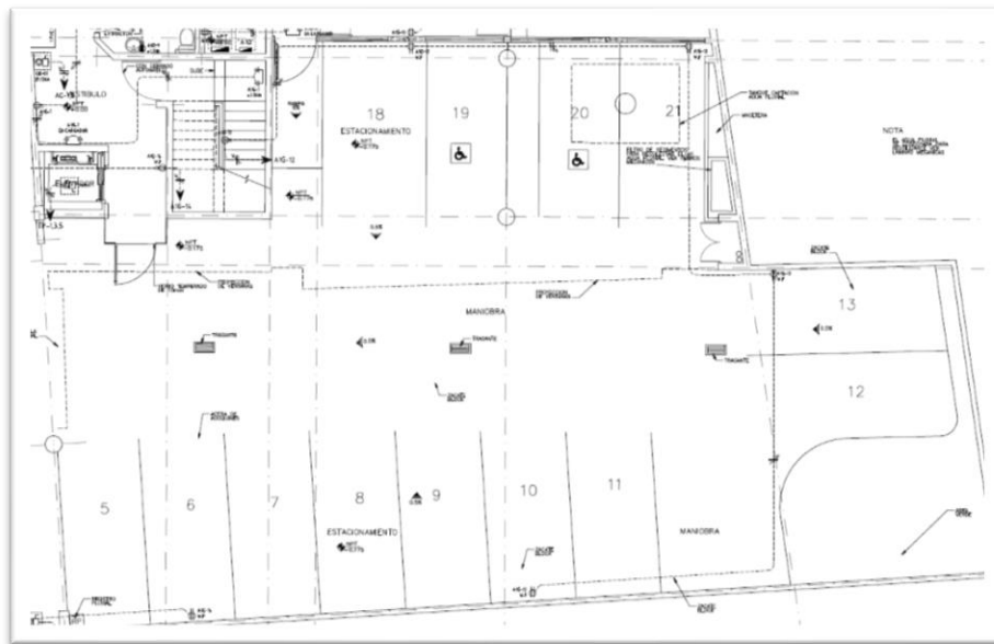
Figura 31. Iluminación de parqueo, vestíbulo y escaleras
