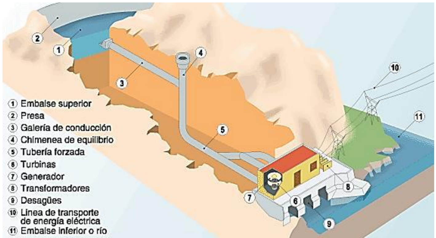
Figura 19. Componentes de una central hidroeléctrica reversible.
