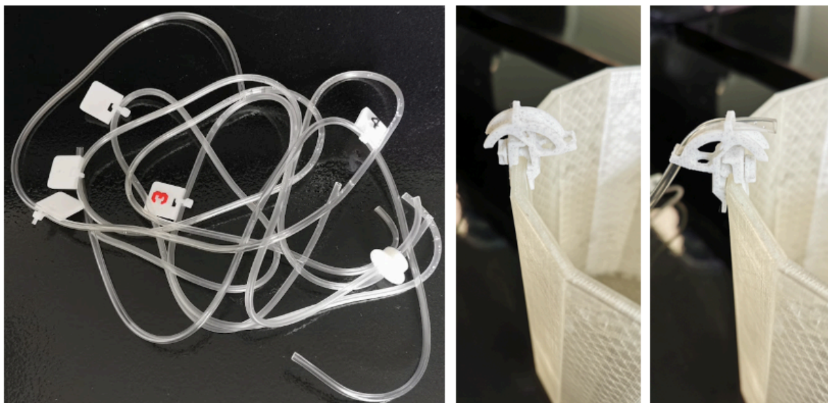
Figura 50. Prensas elaboradas para sostener las mangueras en los compartimentos del sistema abierto monocompartmental, evitando salpicaduras o derrames
