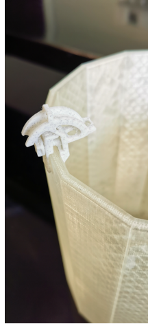
Figura 21. Acomodo de las prensas para las mangueras en los compartimentos A y B
