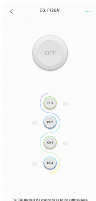
Figura 30. Pantalla principal del control de los canales de la bomba peristáltica
