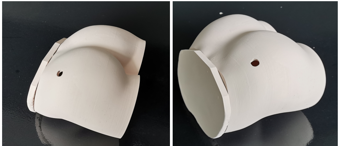
Figura 51. Vistas superiores del fantoma de glúteos elaborado para el sistema abierto monocompartimental
