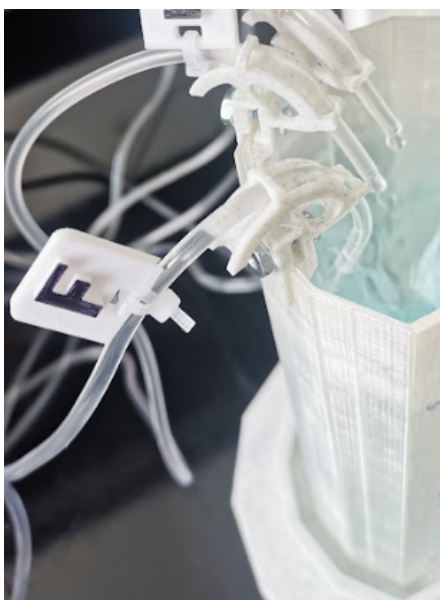
Figura 20. Acomodo de la maguera que proviene del fantoma al compartimento central
