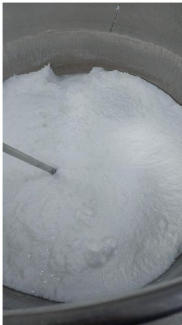
Figura 5. Desarrollo del precipitado y pérdida de homogeneidad completa del sistema durante el descenso de temperatura de la preparación de la solución 2.
