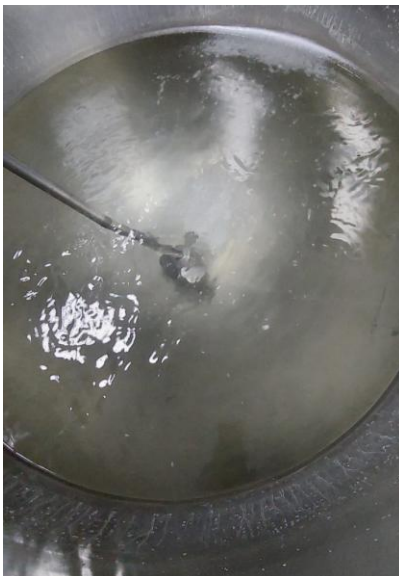
Figura 4. Inicio de formación de agregados blanquecinos durante el descenso de temperatura de la preparación de la solución 2.
