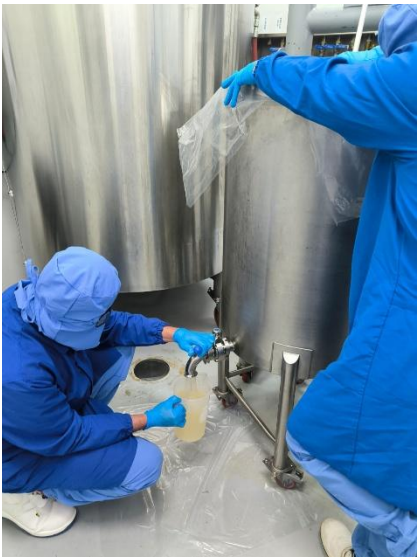
Figura 12. Recirculación del producto como medida correctiva para favorecer la disolución completa del ácido salicílico.
