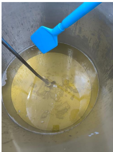
Figura 11. Presencia de grumos de ácido salicílico durante la etapa de disolución en el proceso de manufactura.
