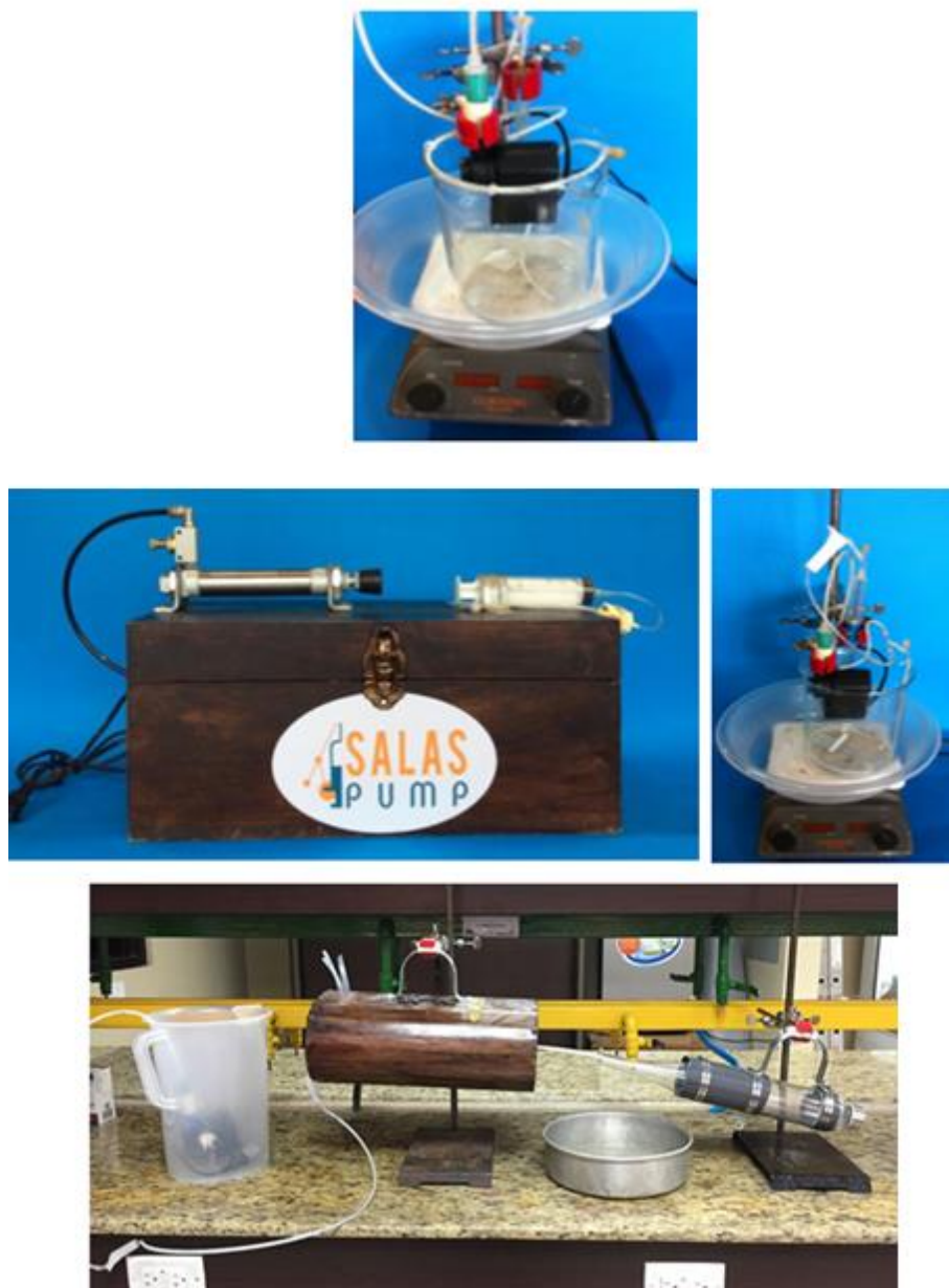
Figura 15. Representación de la comparación del sistema tradicional monocompartimental (Imagen superior) contra el diseño propuesto por Salas (Imágenes del centro) y contra el nuevo sistema monocompartimental extravasal propuesto inicialmente (Imagen inferior).
