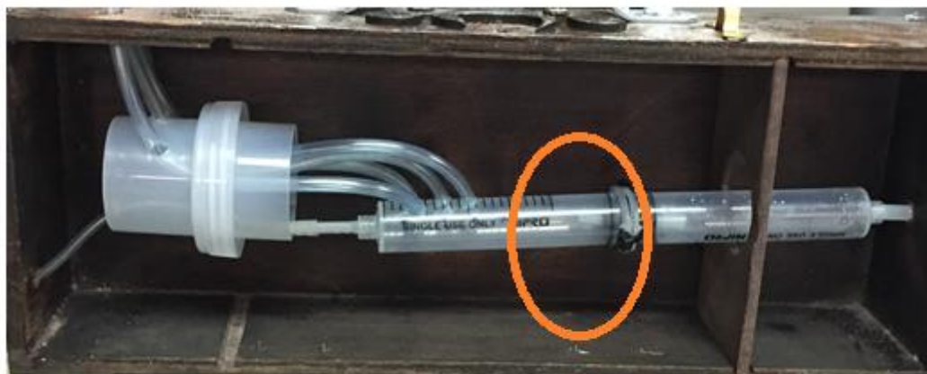
Figura 36. Sitio donde es más conveniente golpear en el sistema bijeringa dentro del administrador.
