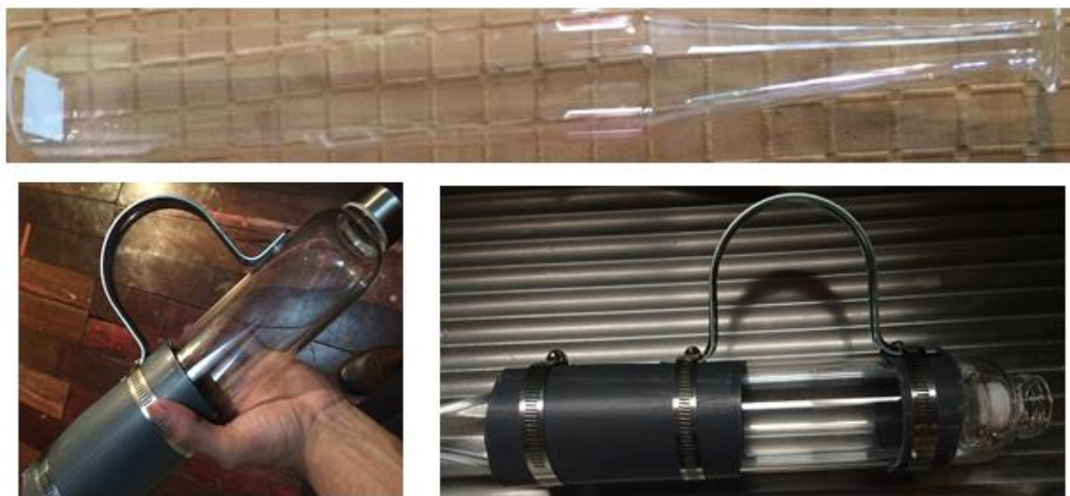
Figura 16. Botellas utilizadas como organismo (Imagen inferior derecha), se muestra la botella que consiste en la parte interna para obtener las concentraciones (Imagen superior) y la botella que se encarga de sostener (Imagen inferior izquierda).
