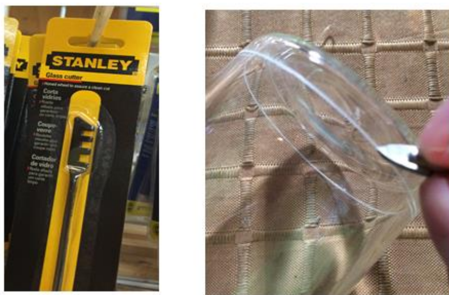
Figura 17. Representación de la forma inicial del corte de la botella exterior del organismo (Imagen de la derecha). Asimismo, se muestra la chispa utilizada para cortar vidrio (Imagen de la izquierda).
