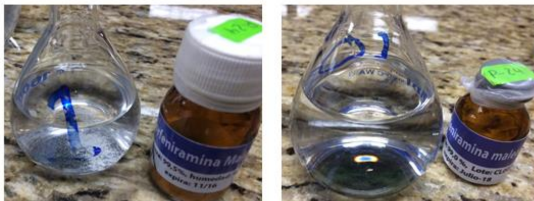
Figura 40. Disoluciones de Clorfeniramina maleato, se evidencia que la imagen de la izquierda presenta un parte del sólido sin disolver y la imagen de la derecha se disolvió en su totalidad.
