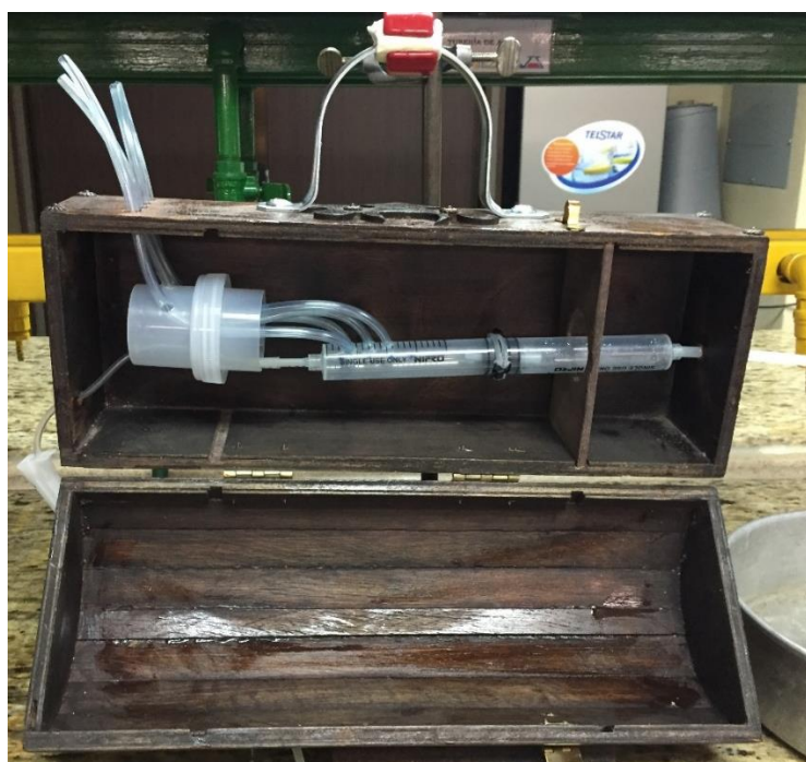
Figura 27. Caja de madera con agarradera o sujetador de metal, picaporte o seguro y agujeros designados estratégicamente, donde ya se colocaron las mangueras y el administrador.
