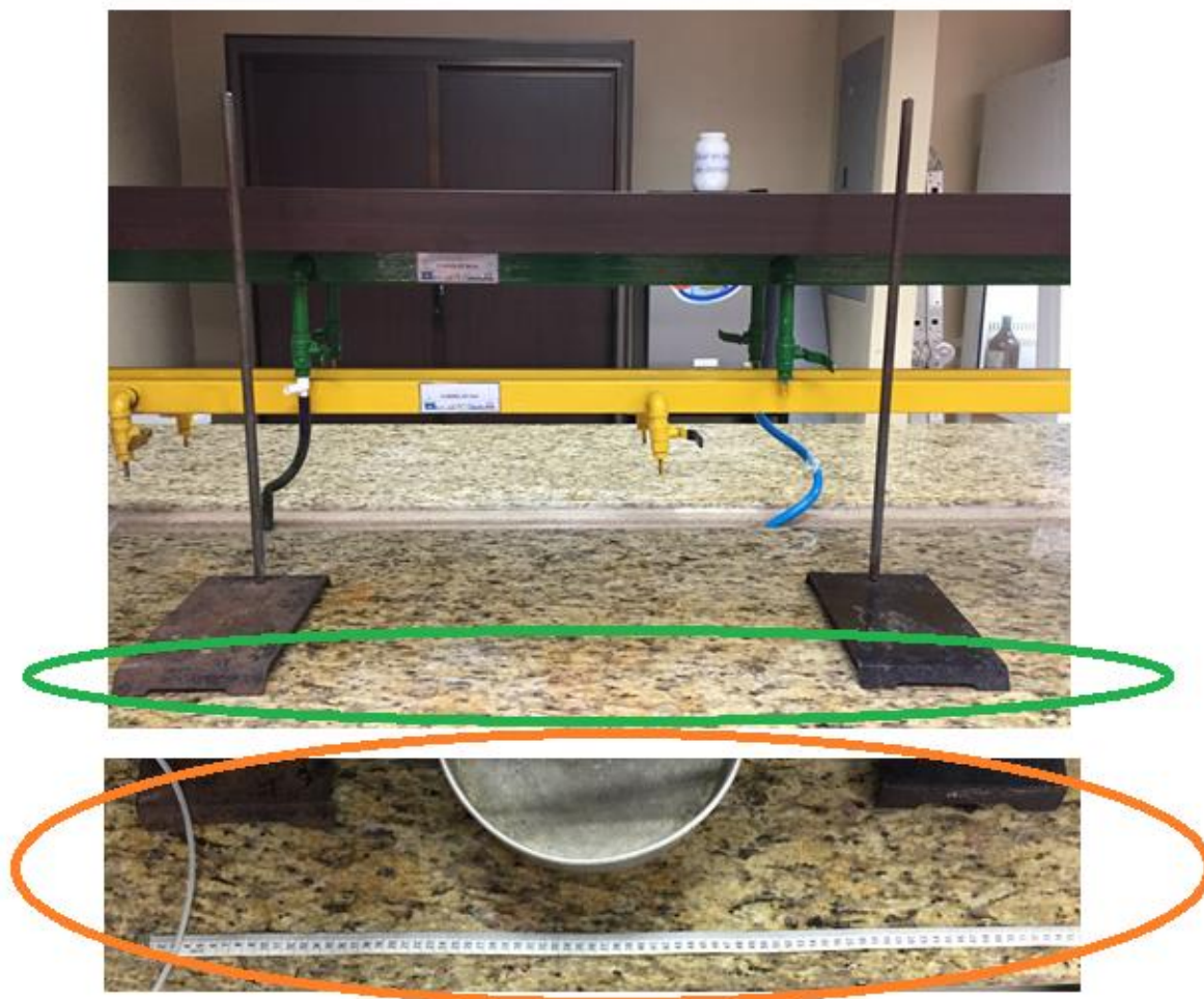
Figura 29. Representación de la medida aproximada en la cual se colocan los soportes metálicos previos a la instalación del equipo.
