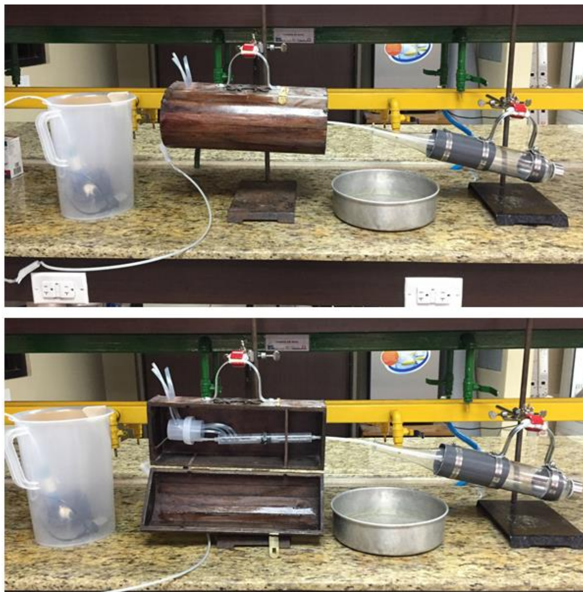
Figura 35. Representación del instrumento extravasal multidosis instalado completamente donde se visualiza el exterior e interior del administrador.
