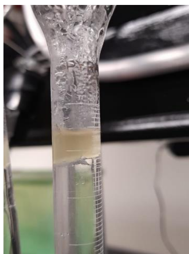
Figura 15. Recolección del aceite esencial producto de la hidrodestilación de los frutos elaborado en el Laboratorio de Química de la Universidad Iberoamericana
