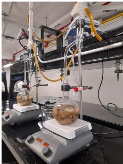
Figura 14. Proceso de hidrodestilación de los frutos elaborado en el Laboratorio de Química de la Universidad Iberoamericana
