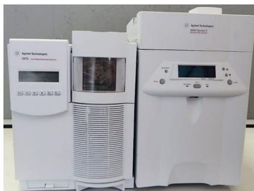
Figura 17. Cromatógrafo de gases acoplado a detector de masas disponible en el Laboratorio de Química de la Universidad Iberoamericana
