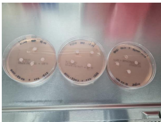
Figura 63. Lectura inicial a las 0 horas de la prueba antimicótica del aceite esencial de las hojas del P. costaricense
