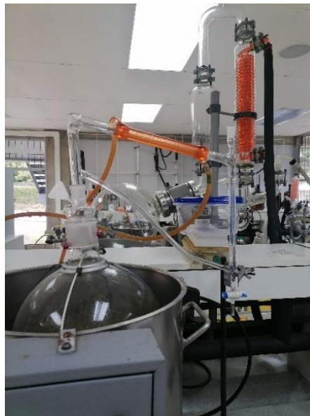
Figura 11. Proceso de hidrodestilación de las hojas elaborado por los servicios del Centro de Investigaciones en Productos Naturales
