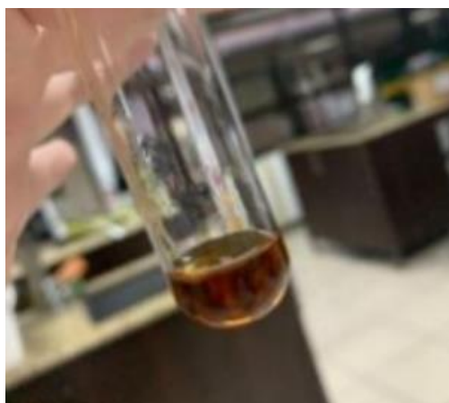
Figura 32. Prueba de vainillina-ácido sulfúrico del aceite esencial de las hojas del P.costaricense
