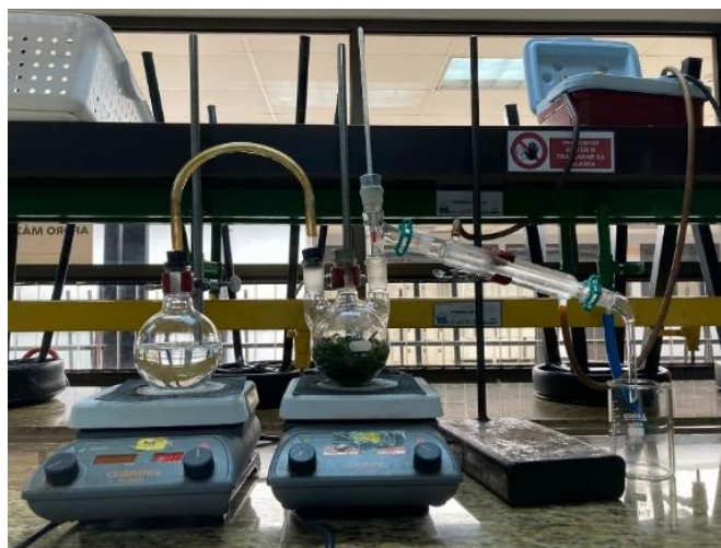
Figura 7. Proceso de arrastre con vapor de las hojas elaborado en el Laboratorio de Química de la Universidad Internacional de las Américas
