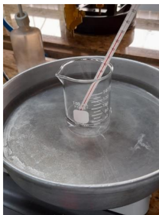
Figura 24. Prueba de evaporación del agua y separarlo del aceite
