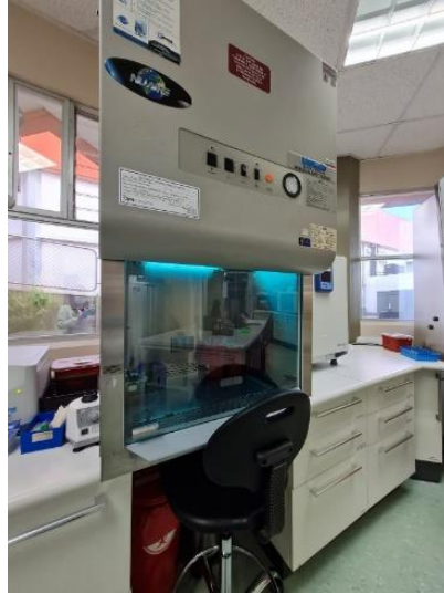
Figura 19. Cámara de flujo laminar con luz UV tipo II para esterilizar círculos que serán impregnados por el aceite, equipo del Laboratorio Clínico y Banco de Sangre de la UCR
