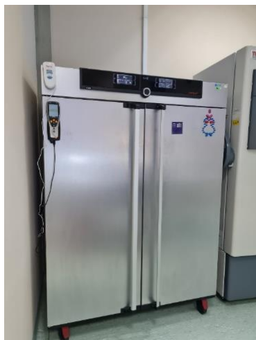
Figura 21. Incubadora utilizada a una temperatura aproximada de 33,7°C-34,0°C disponible en el Laboratorio Clínico y Banco de Sangre de la UCR
