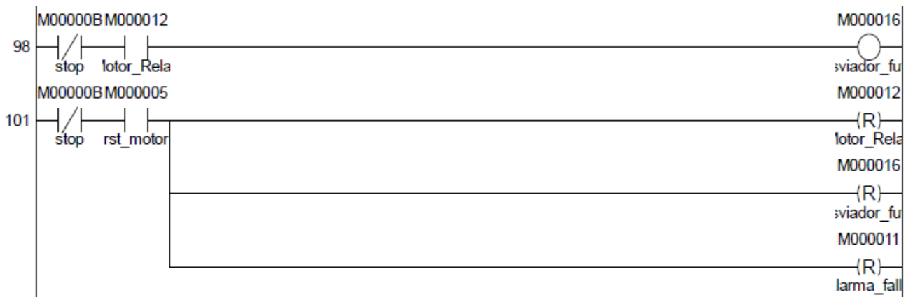
Figura 45. Figura de programa 4, desviador y puesta en marcha
