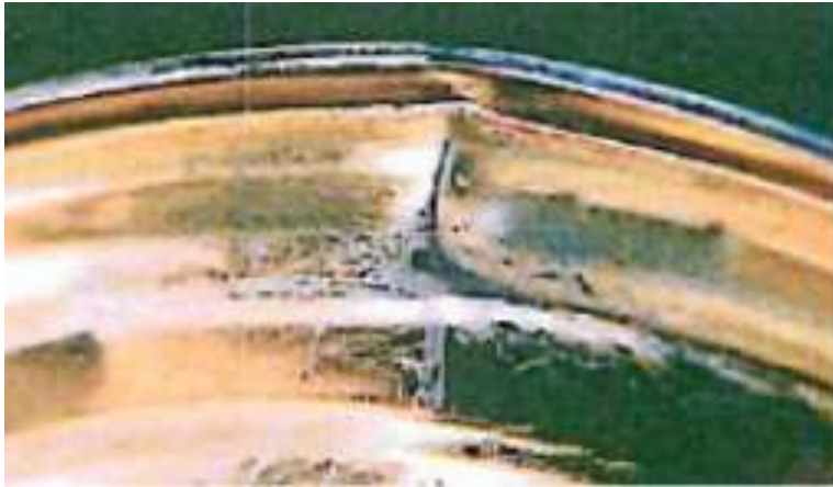
Figura 18. Daño en sello de envase hojalata
