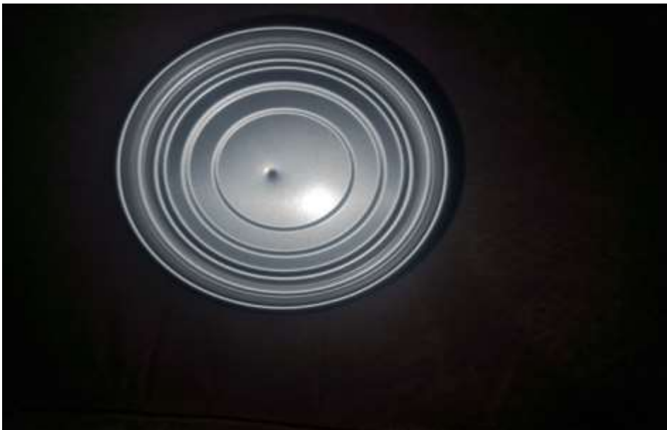
Figura 69. lata con falla en el fondo
