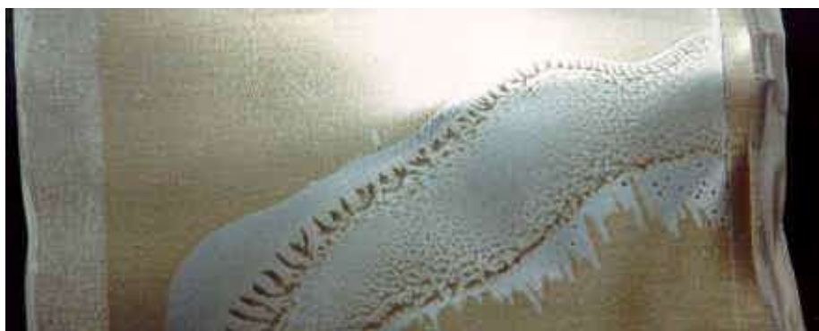
Figura 17. Defecto En La Película De Barniz
