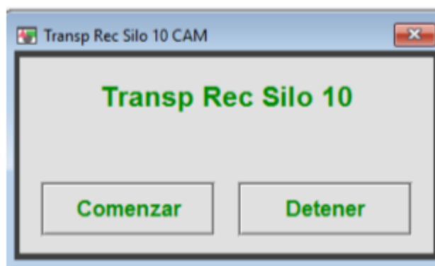
Figura 23 Menú de arranque manual de equipos Fuente: Propia
