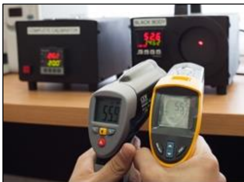
Figura 6: Calibración de temperatura por comparación directa
