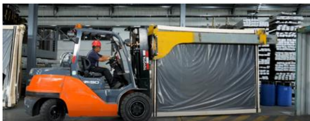
Figura 37 Descarga de la caja de vidrio
