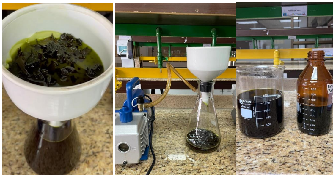
Figura 33. Equipo para filtración al vacío del material macerado de las hojas de Vernonia patens y beacker con el extracto
