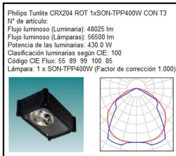
Figura N.º 25: Datos importantes de la luminaria Tunlite Sodio A/P
