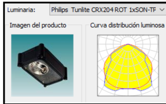
Figura N.º 27: Distribución fotométrica de luminaria Tunlite Sodio A/P
