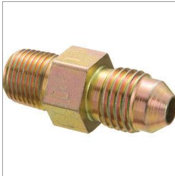
Figura 26. Conector recto de acero macho NPT de 1/4" a macho JIC N2 de 1/4". Fuente: (Fabricante EATON, 2019).
