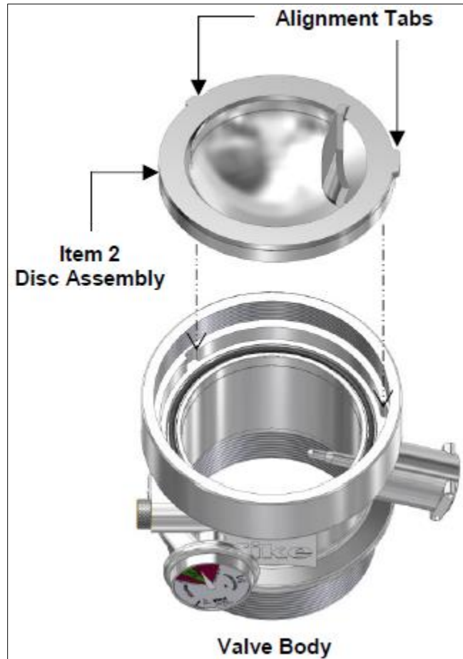
Figura 49. Instalación del disco en la válvula de impulso (Fabricante Fike Corporation, 2020).
