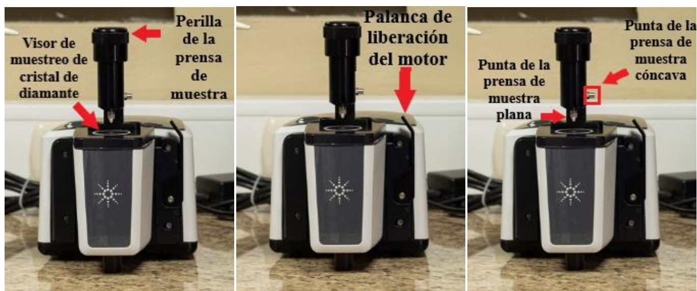
Ilustración 25. Partes del espectrofotómetro IR Cary 630 FTIR
