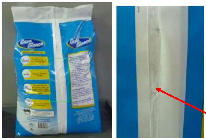
Figura 26. Problemas de Sello Vertical
