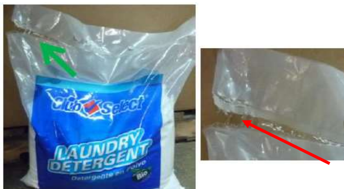
Figura 25. Problemas con el sello horizontal
