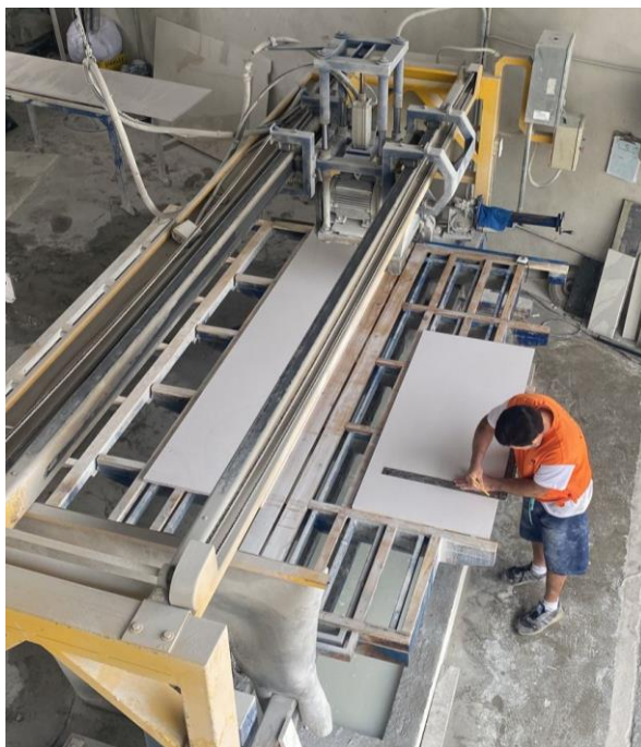
Ilustración 5 Proceso de medición de las superficies
