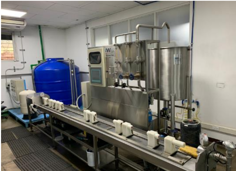
Ilustración 27: Banco de pruebas medidores DN15 (Laboratorio de Flujo)
