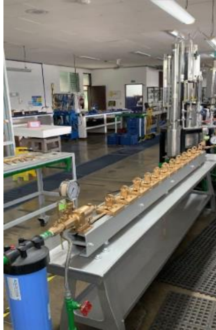
Ilustración 28: Bancada de pruebas #2 Ford DN15, 6 medidores.
