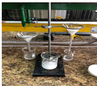
Filtración del extracto
