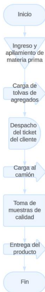
Figura 18 Diagrama de procesos de producción de concreto premezclado
