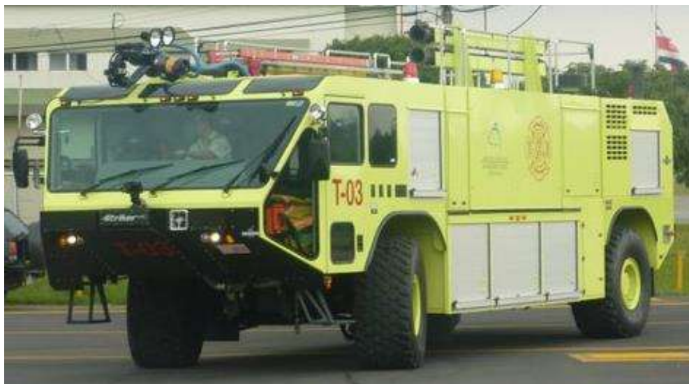
Figura #11: Unidad tipo tanque aeroportuario
