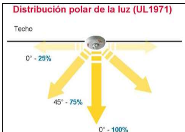
Figura 84. Distribución polar de la luz según UL 1971.
