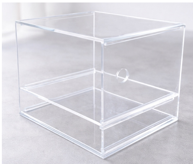
Figura 18. Base acrílica de soporte para el agitador magnético y la bomba peristáltica.
