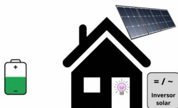
Instalación de autoconsumo fotovoltaico aislada de la red
