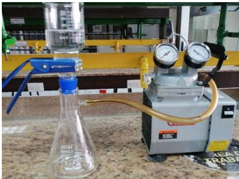
Figura 35. Filtración de las muestras del experimento 2 al cabo de varios días mediante filtración al vacío
