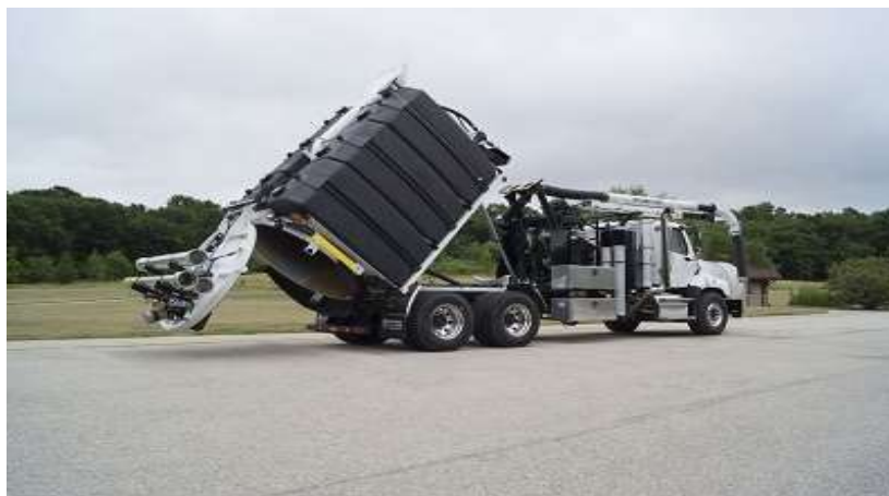
Figura 2.10. Sistema hidráulico Camel 200
