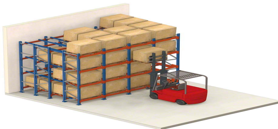
Figura 29. Sistema de almacenamiento "Push Back"
