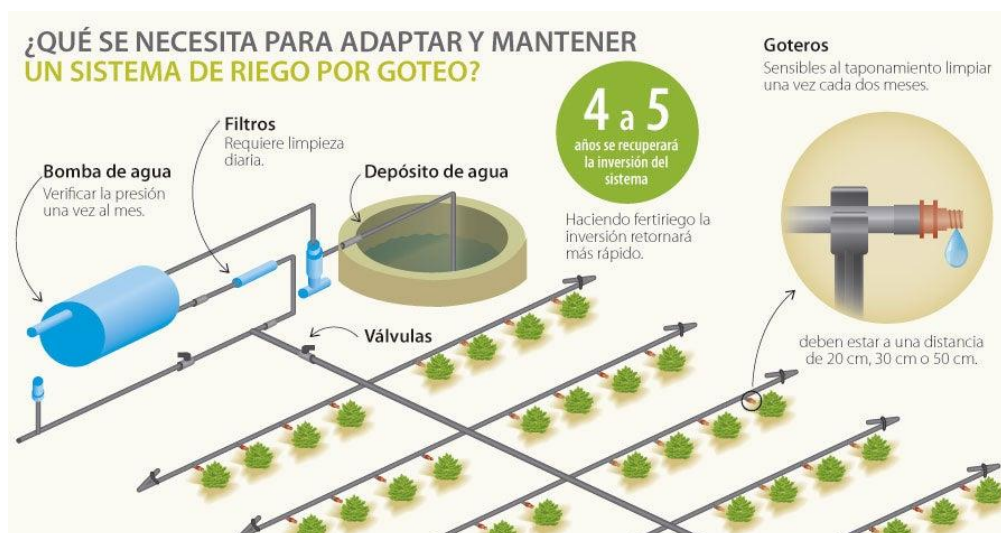
Ilustración 1 Sistema de riego por goteo
