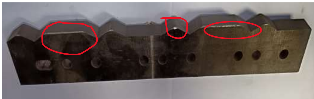
Ilustración 13 Daño en cuchilla por mal ajuste
