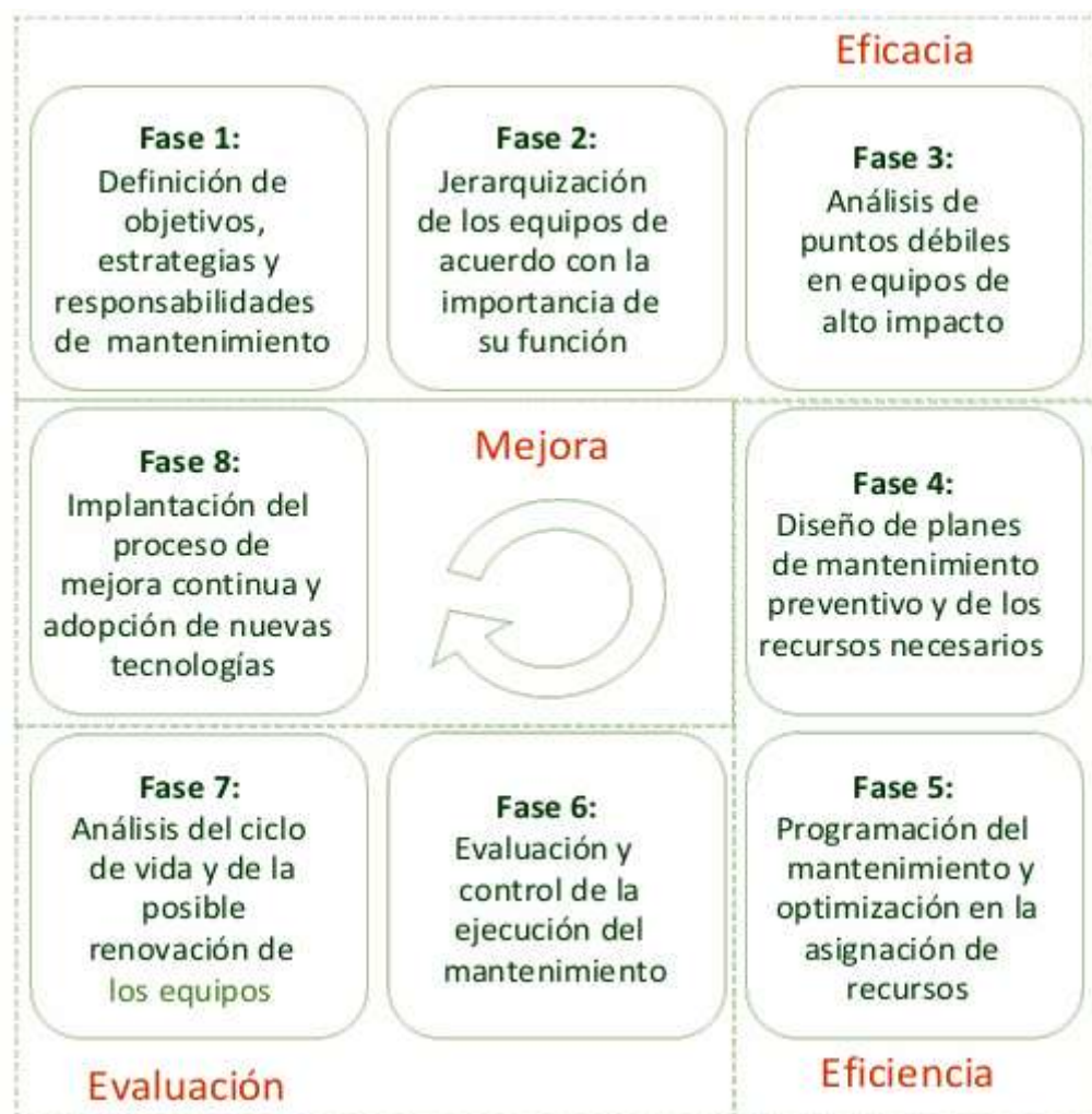
Ilustración 7 Modelo del proceso de gestión del mantenimiento
