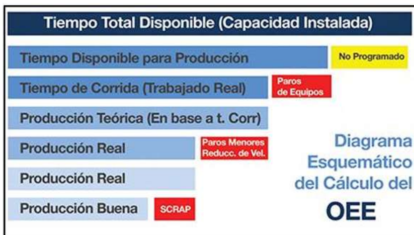
Ilustración 12 Diagrama esquemático del cálculo del OEE
