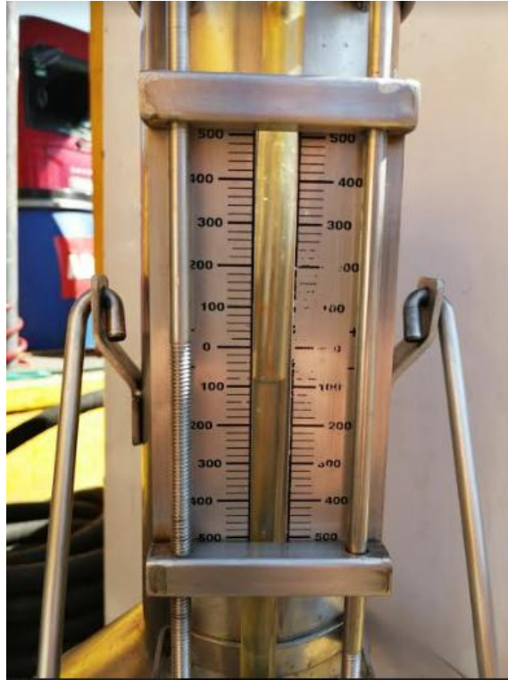
Figura 8. Escala de medida del Serafín o Medidor Volumétrico. Elaboración propia.
