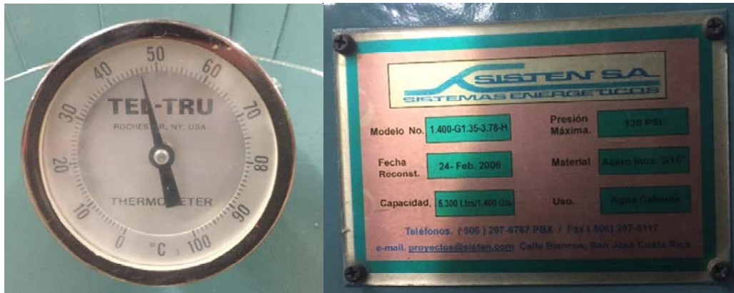
Figura A.4 Temperatura de operación y datos tanque almacenamiento de Torre Norte
