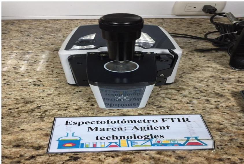
Figura 22. Espectrofotómetro infrarrojo empleado en la caracterización de las muestras del patrón de aceite esencial de tomillo vs. el extracto de aceite esencial de tomillo
