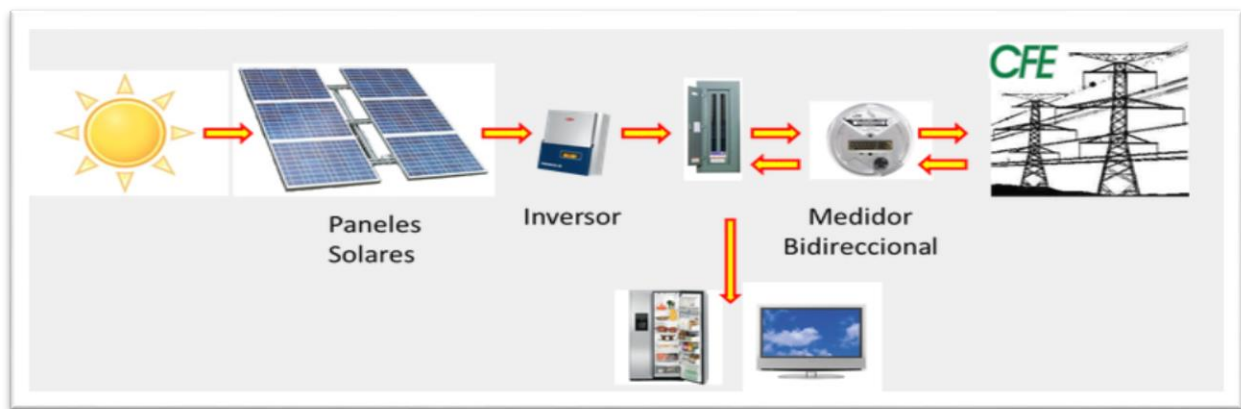
Figura 2.1. Interconexión de un sistema fotovoltaico.
