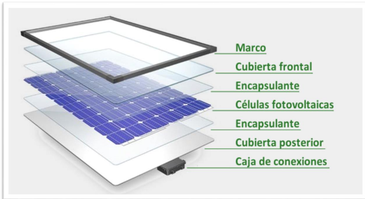
Figura 2.2. Partes de un panel Fotovoltaico.
