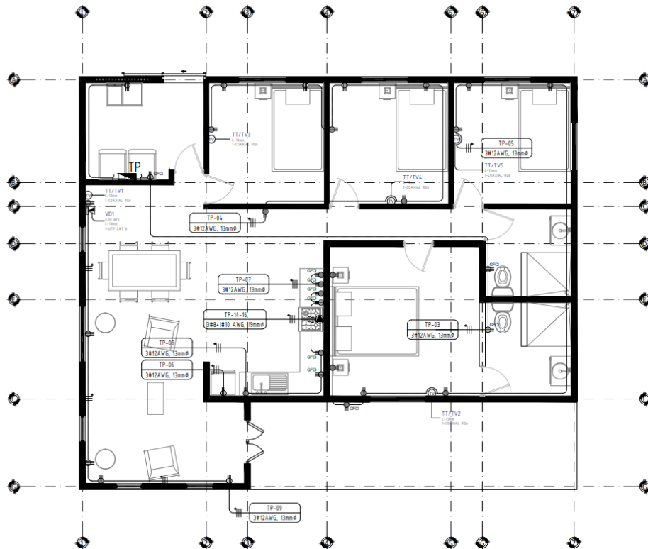
PLANTA DE DISTRIBUCIÓN DE TOMACORRIENTES
