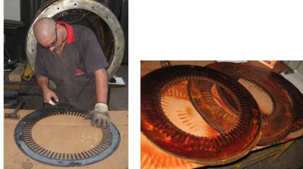
Ilustración 19. Proceso de reparación laminado
