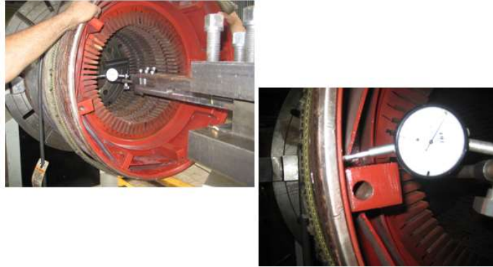
Ilustración 21. Verificación mecánica posición del Núcleo
