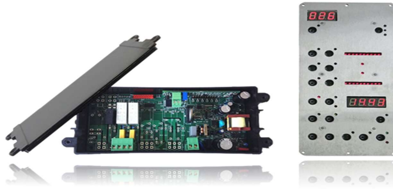
Ilustración 9. Controlador dos estaciones
